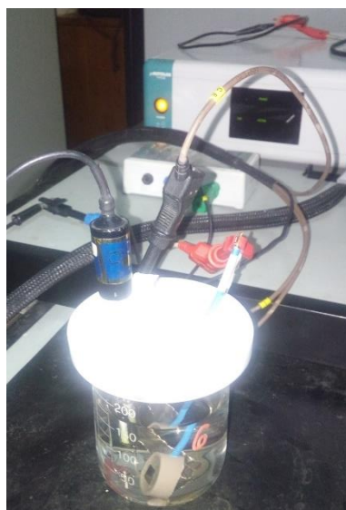
Figura 4.13 - Potenciostato galvanostato \mu Autolab. 1- Calomelano saturado. 2-Eletrodo de trabalho (amostra). 3-Contra-eletrodo (platina)
