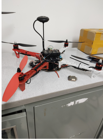
Figura 19 – Imagens do modelo de UAV montado de baixo custo, ainda sem gimbal e câmera. Fonte: Próprio Autor
