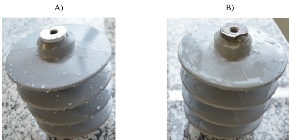
Figura 36 – Molhabilidade de para-raios de distribuição: A) Para-raios novo, superfície hidrofóbica; B) Para-raios envelhecido, superfície hidrofílica. Fonte: [33].
