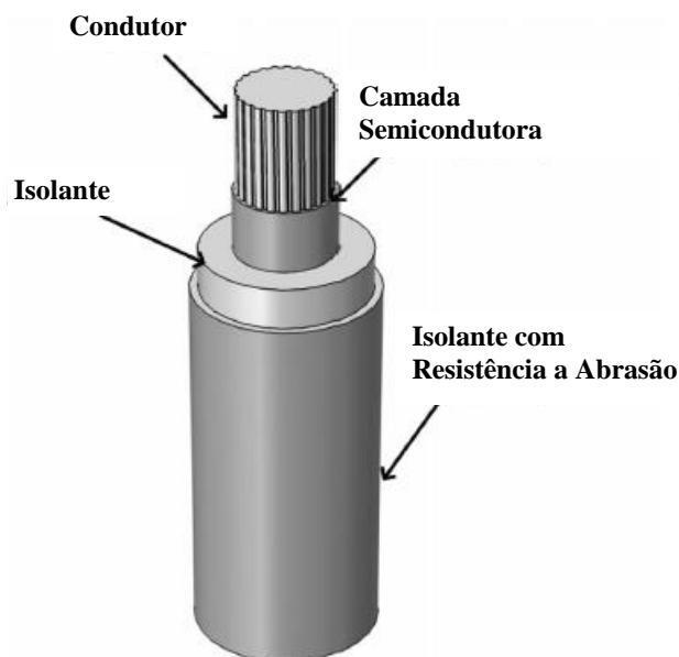
Figura 2 – Ilustração de um cabo coberto. Fonte: adaptado de [28].
