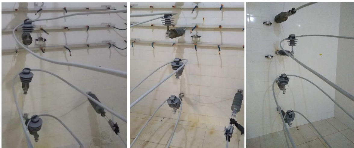
Figura 29 – Disposição das amostras na área de ensaio de envelhecimento. Fonte: próprio autor.
