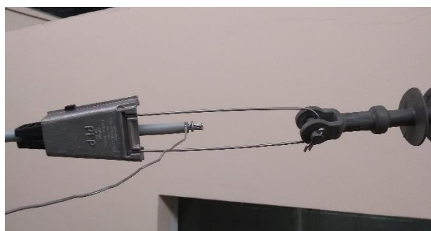
Figura 43 – Grampo para fixação das extremidades do cabo coberto ensaiado e conexão entre o condutor do cabo e o gerador de impulsos atmosféricos através de um tento de alumínio. Fonte: próprio autor.
