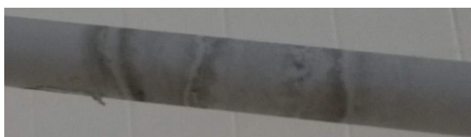
Figura 54 – Trilhamento nos cabos envelhecidos em 500 horas no primeiro método de envelhecimento. Fonte: próprio autor.
