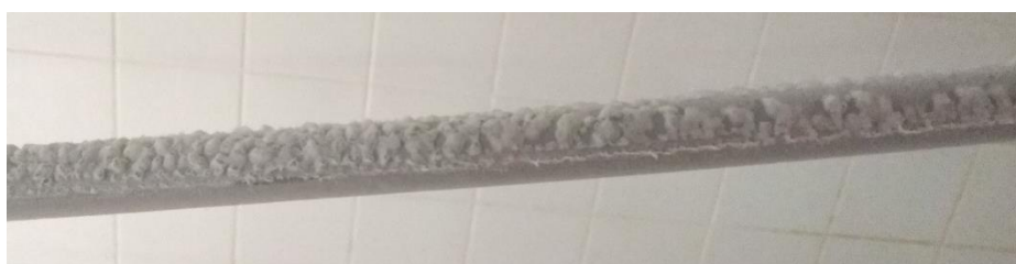
Figura 64 – Acúmulo de sal no cabo coberto no decorrer do ensaio de envelhecimento de 500 horas do segundo método de envelhecimento. Fonte: próprio autor.
