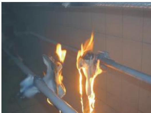
Figura 19 – Incêndio em um espaçador devido a ocorrência de descargas parciais, trilhamento e erosões no material durante o ensaio de compatibilidade dielétrica. Fonte: [4].
