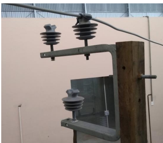
Figura 42 – Arranjo para o ensaio de impulso atmosférico na RDC, com a estrutura CE2 perpendicular ao cabo coberto. Fonte: próprio autor.
