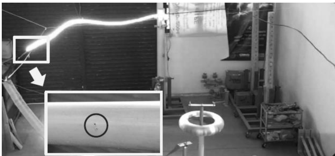
Figura 14 – Descarga disruptiva plena perfurando a camada isolante do cabo em um local distante da estrutura. Fonte: [2].
