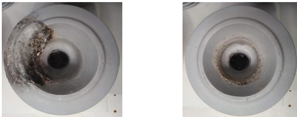
Figura 52 – Exemplos de trilhamento, erosão e carbonização dos isoladores poliméricos em suas cavidades inferiores, durante a primeira tentativa de envelhecimento. Fonte: próprio autor.
