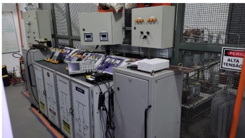
Figura 36. Bancada de cargas e setup de medidores do laboratório de média tensão
