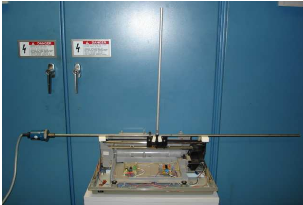
Figura 6.3 – Protótipo do pêndulo invertido montado.
