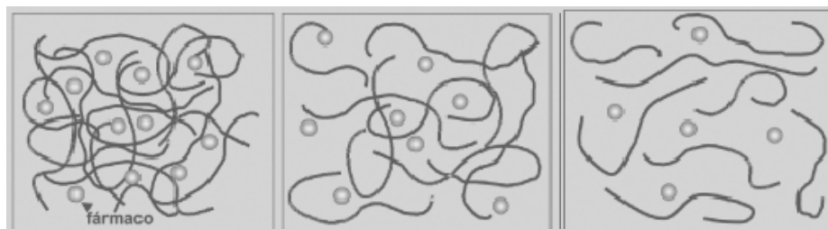
Figura 4 –Esquema das configurações macromoleculares dos polímeros hidrofílicos durante o processo de liberação do fármaco.
