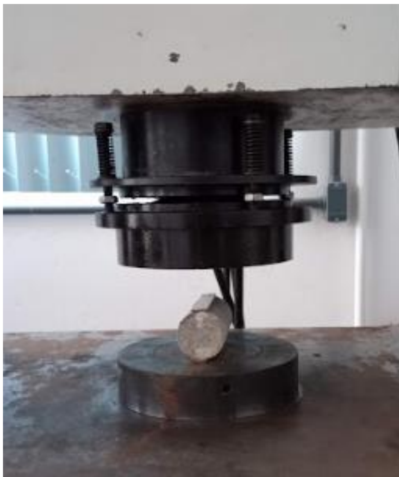
Figura 23 – Ensaio de Resistência à tração por compressão diametral
