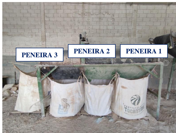
Figura 15 - Moinho com três peneiras na empresa RANERI
