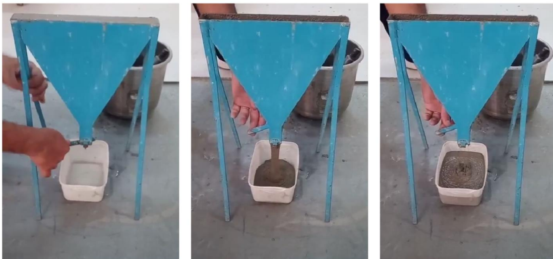
Figura 18 - Ensaio de viscosidade para obter o tempo de escoamento
