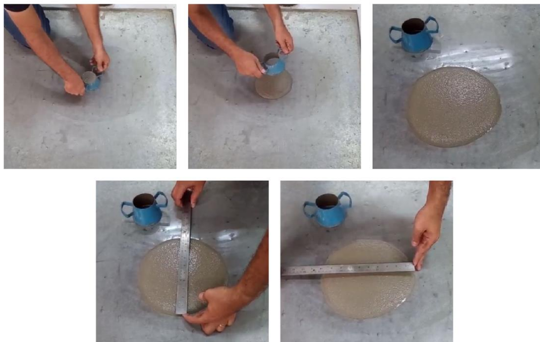
Figura 19 - Execução do ensaio de fluidez para obter o diâmetro de espalhamento
