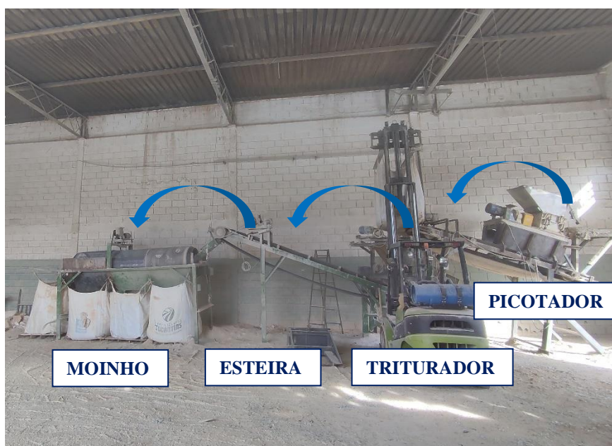
Figura 14 - Processo de Trituração de Resíduo de Vidro na empresa RANERI
