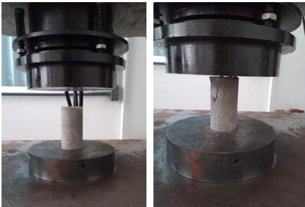
Figura 22 – Ensaio de resistência a compressão axial
