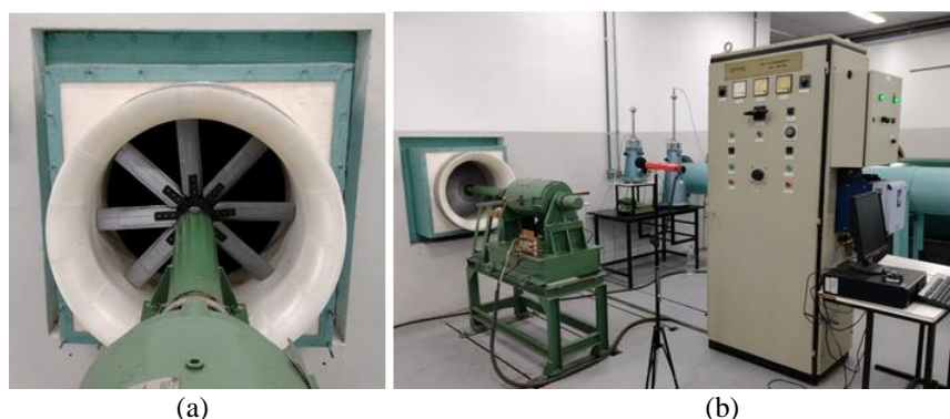
Figura 4.13 – (a) VA com carcaça e bocal; (b) Conjunto de acionamento do VA
