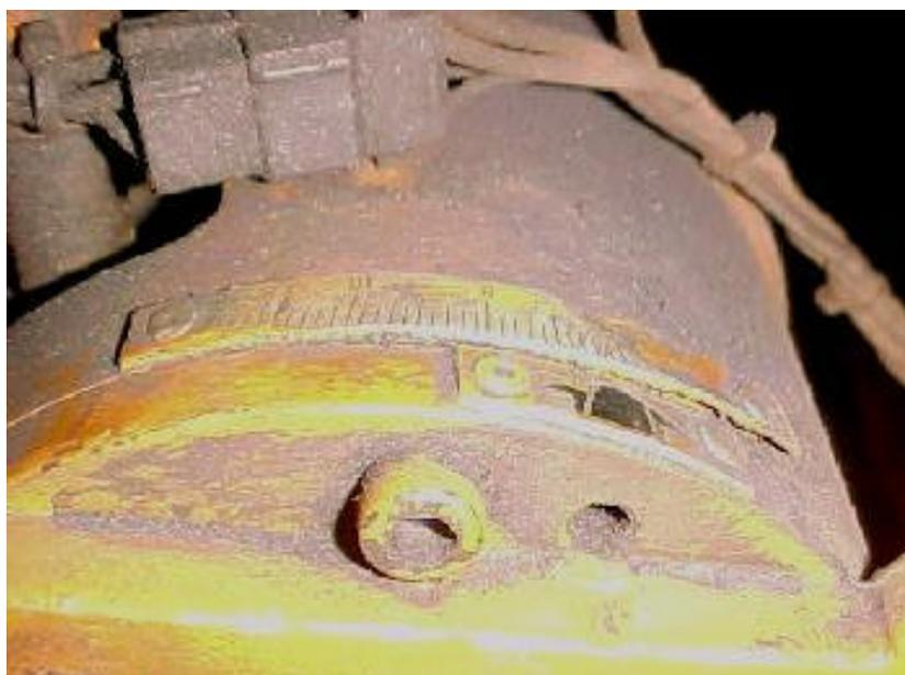
**Figura 4.8** – Método de variação do ângulo longitudinal.
