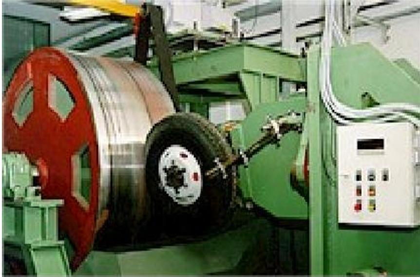
**Figura 5.24** – Máquina de testes de compressão MAXION.
