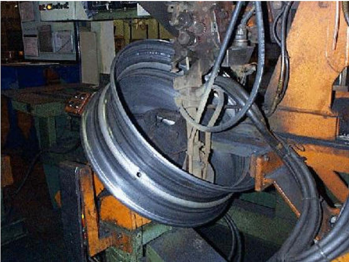
**Figura 4.5** – Estação de solda MIG/MAG nº 01 com a roda no posicionamento inicial.
