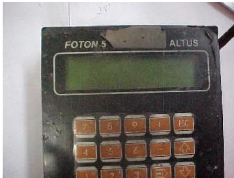
**Figura 4.10** – Controlador FOTON 5 – utilizado na variação da velocidade de solda.
