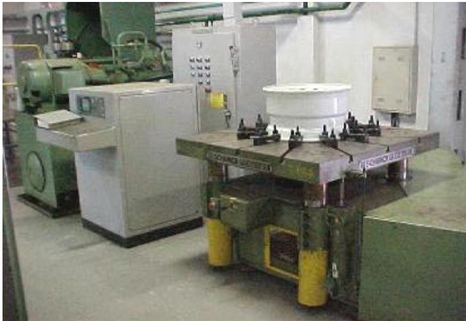
**Figura 5.23** – Máquina de testes de fadiga do disco SCHENCK-PEGASUS.
