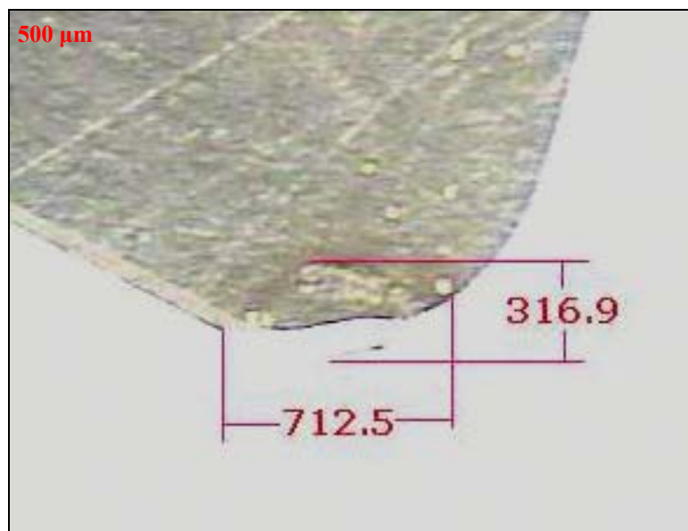
Figura 6.16 – Lascamento e desgaste de cratera na ferramenta CC 650 convencional (torno Romi, cotas em \mu\text{m} ).
