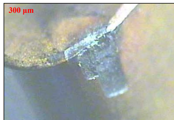
Figura 6.39 – Desgaste de cratera e avaria na ferramenta de geometria convencional, que usinou 18 peças ( V_c=250 m/min. e f=0,08 mm/v)
