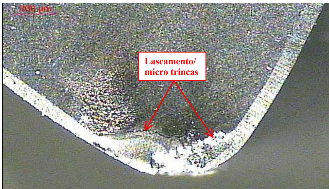
Figura 6.12 –Avarias (lascamento) na ferramenta CC 650 alisadora.
