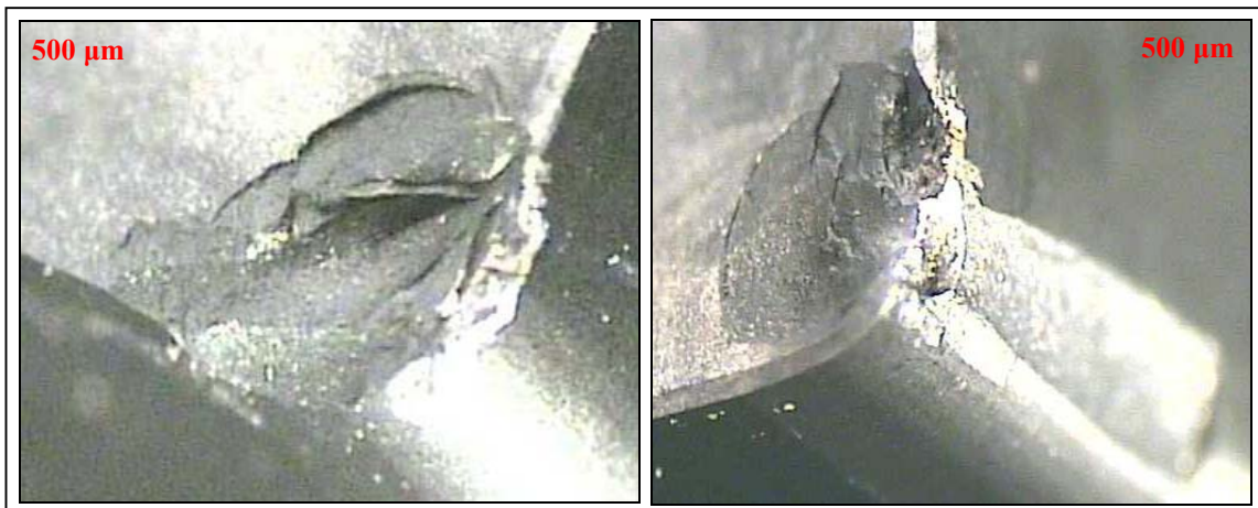
Figura 6.33 – Quebra da ferramenta de geometria alisadora ( V_c=200 m/min. e f=0,2 mm/v).
