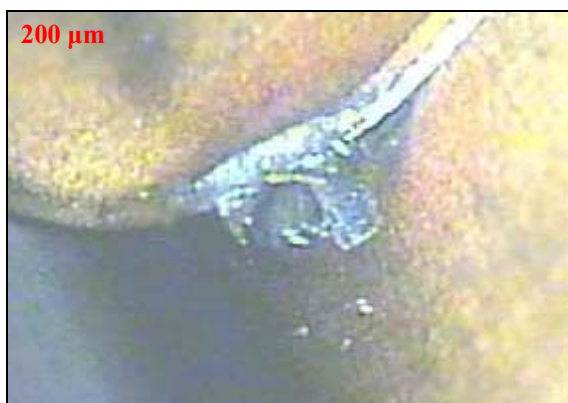
Figura 6.38 – Desgaste de cratera, flanco e avaria na ferramenta de geometria convencional que usinou 38 peças ( V_c=200 m/min. e f=0,08 mm/v)
