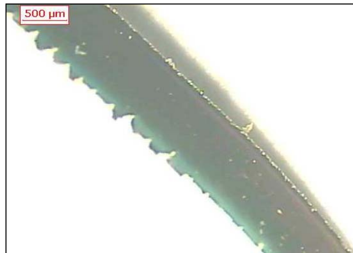
Figura 6.24 – Cavaco dente de serra em forma de fita.
