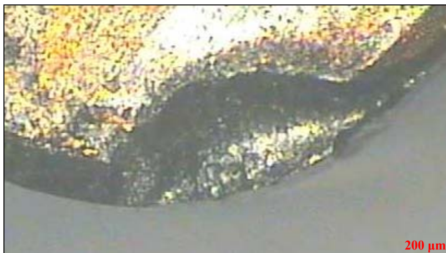
Figura 6.43 – Desgaste de cratera na ferramenta alisadora que usinou 64 peças ( V_c=150 m/min. e f=0,15 mm/v).
