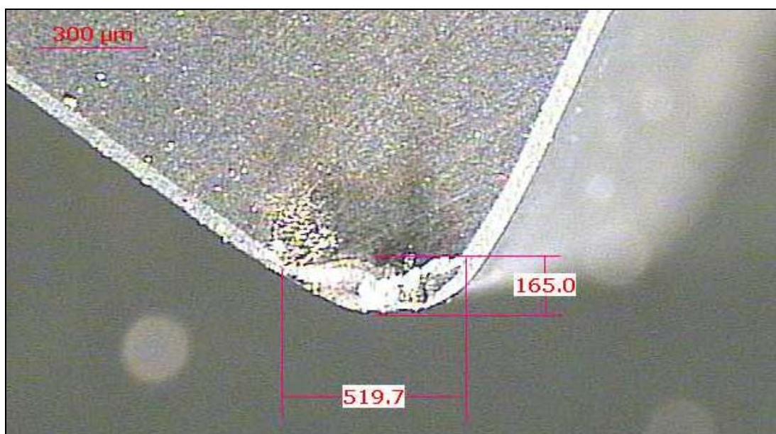
Figura 6.11 –Avarias (lascamento) na ferramenta CC 650 alisadora (cotas em μm).
