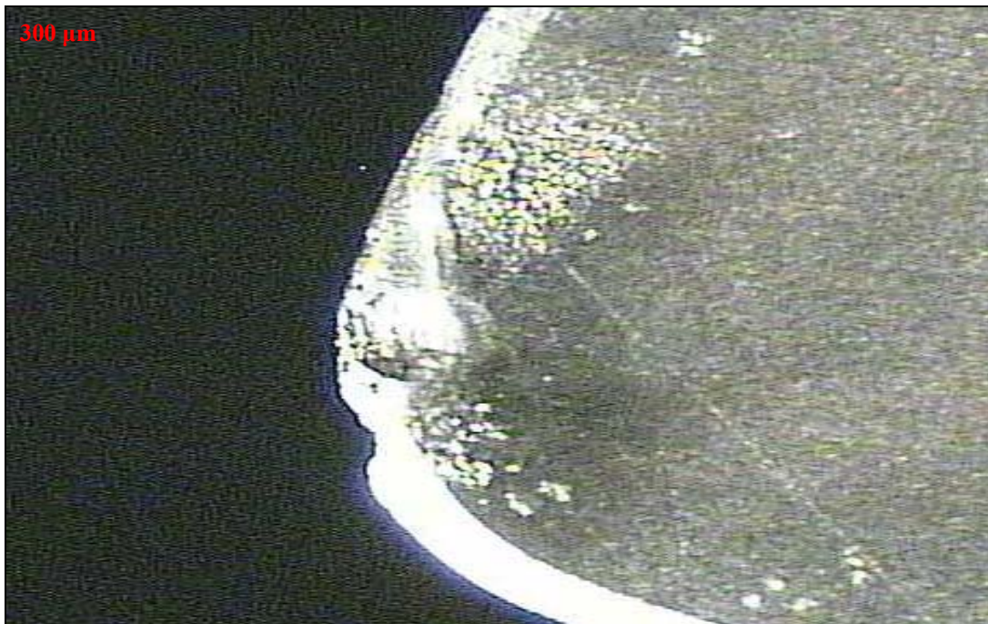
Figura 6.17 – Lascamento e desgaste de cratera na ferramenta CC 650 alisadora (torno Romi).
