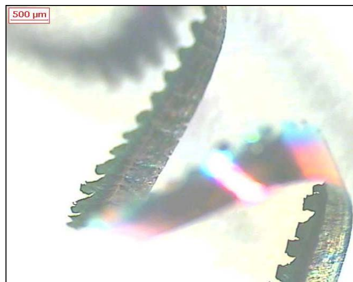
Figura 6.25 – Cavaco dente de serra em no formato helicoidal.
