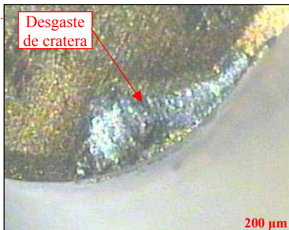
Figura 6.41 – Desgaste de cratera na ferramenta alisadora que usinou 14 peças ( V_c=200 m/min. e f=0,20 mm/v).
