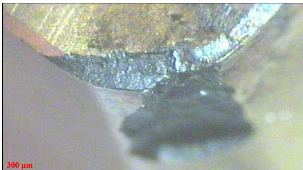
Figura 6.40 – Desgaste de cratera e avaria na (quebra) ferramenta de geometria alisadora, que usinou 21 peças ( V_c=150 \text{ m/min.} e f=0,20 \text{ mm/v} )
