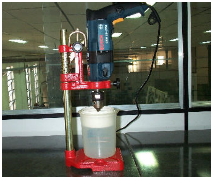
Figura 5.5 – Homogeneização da Emulsão de Água em Óleo.
