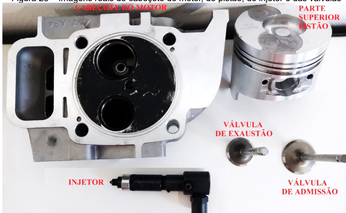
Figura 23 – Imagens reais do cabeçote do motor, do pistão, do injetor e das válvulas
