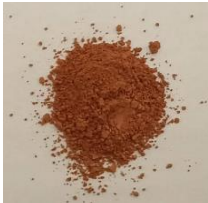
Figura 16 - Nanopartículas de sílica funcionalizadas com óxido de cobre (SBA-16@CUO)
