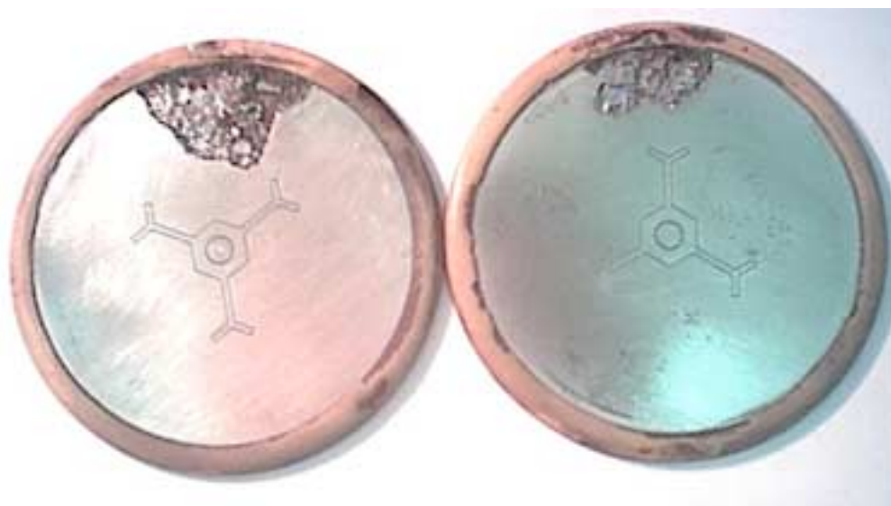
Figura 6.6 – Tiristores BstT 68H280S15 – falha tipo VI.
