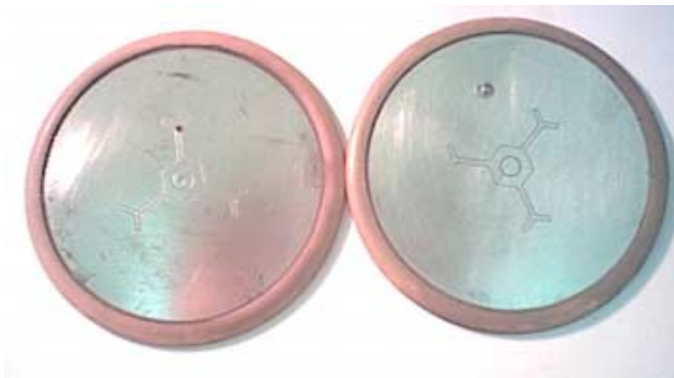
Figura 6.5 - Tiristores BstT 68H280S15 – falha tipo V.
