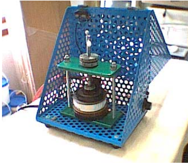
Figura 7.2 – Prensa para ensaios dos semicondutores.
