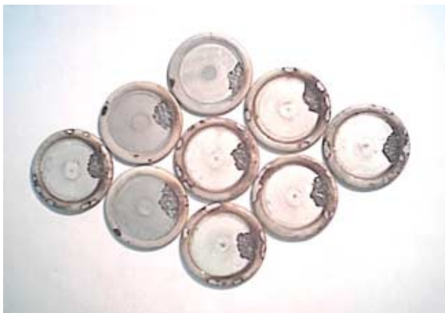
Figura 6.3 - Diodo tipo FD500EV-70 - Falha Tipo III.
