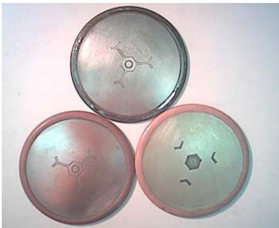
Figura 6.7 – Tiristores BstT 68H280S15 – falha tipo VII.
