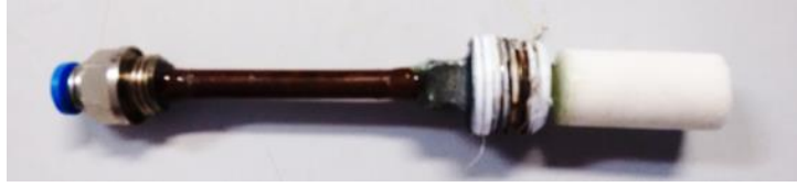
Figura 3-8: Bico difusor para injeção do ar comprimido.
