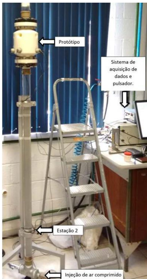
Figura 3-10: Fotografia da montagem experimental simplificada para medição de FVG utilizando o carretel ultrassônico.
