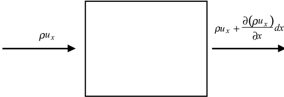
Figura 2 – Fluxo de massa na direção x em um volume fluido
