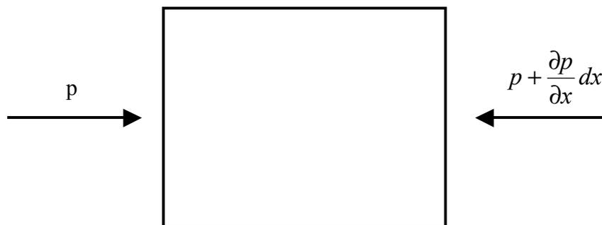
Figura 3 – Volume fluido sob a ação de forças devido a pressão
