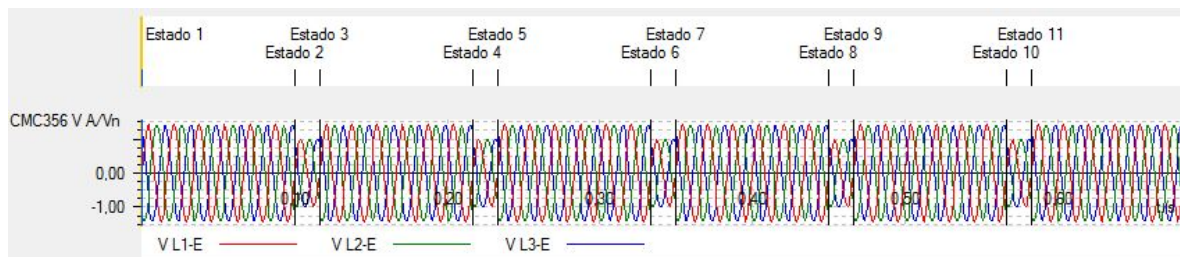
Figura IV.1 - Afundamentos trifásicos de tensão com magnitude de 70% e duração de 16,67 ms.
