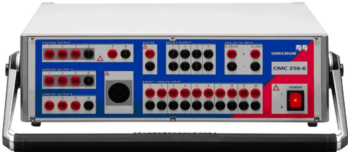
Figura III.1 - Fonte programável geradora de sinais de tensão e corrente, modelo CMC 256-6.
