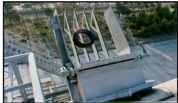
Figura 4.2- Instalação de válvula pêndulo no meio do forno Fonte:ERAtch - TMI Systems
