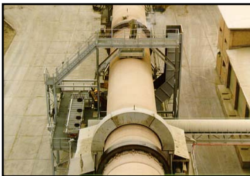
Figura 4.1- Sistema de introdução no meio do forno Fonte: ERAtch - TMI Systems
