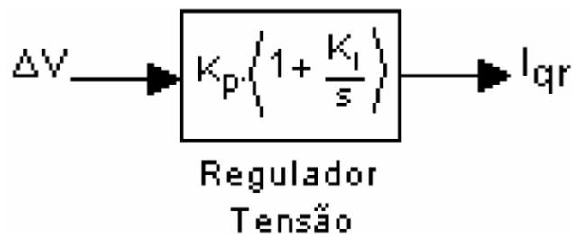
Figura 39 – Regulador de Tensão do *STATCOM*.
