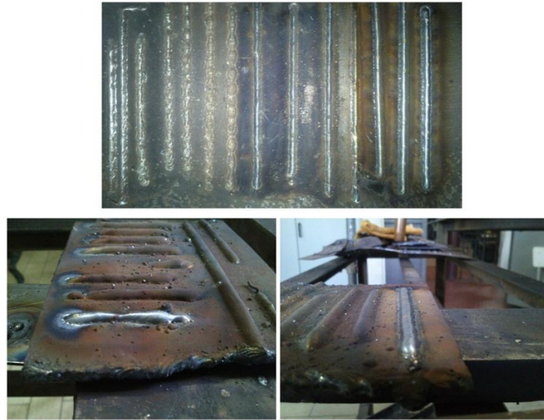
Figura 3.2 – Cordões gerados em testes preliminares.
