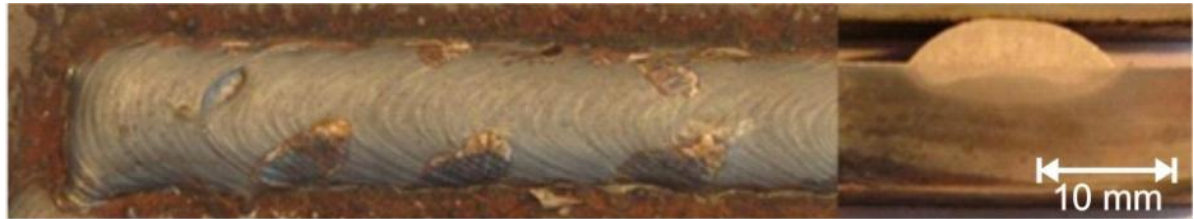
Figura 2.9 – Formato do cordão obtido com variação da velocidade de alimentação nas polaridades positiva e negativa. Fonte: Puhl (2011).
