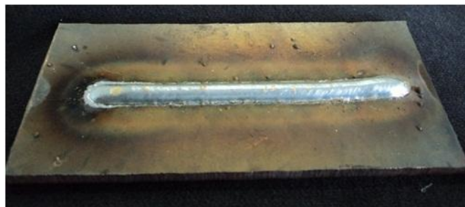
Figura 3.5 – Deposição do cordão de solda sobre a chapa.
