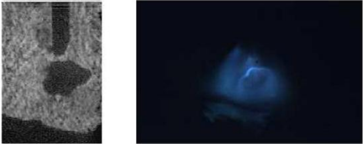
Figura 2.5 – Transferência metálica operando com EN 50% e formato de onda “A”. Fonte: Nascimento (2011).
