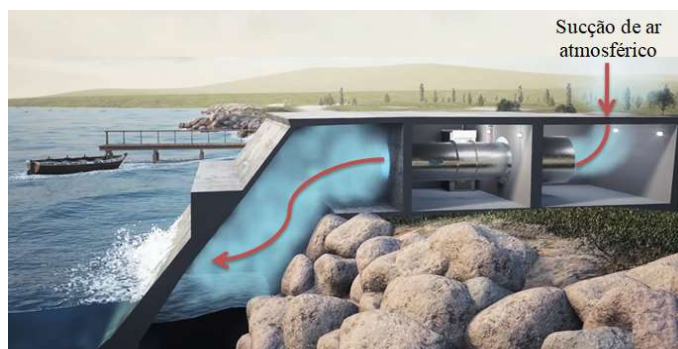
Figura 2.16 – Detalhe do interior da UCAO onshore no momento em que há a despressurização da câmara com sucção de ar para dentro da CAO
