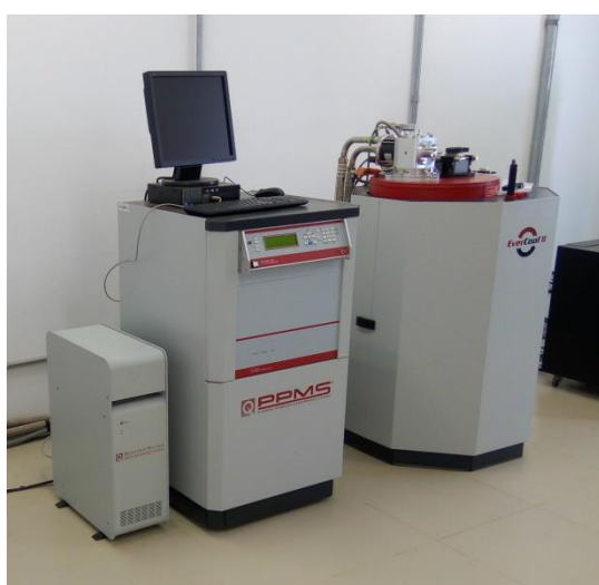
Figura 3.3 – Foto do equipamento PPMS no qual foram realizadas as medições de magnetotransporte com e sem iluminação. O porta-amostras é inserido no componente à esquerda.
