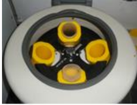
Figura 17: Alocação dos tubos na centrífuga (posição cruzada)
