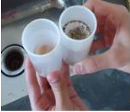
Figura 16: Tubos de centrífuga, um contendo apenas água e o outro contendo o retido em peneira de 0,053 mm
