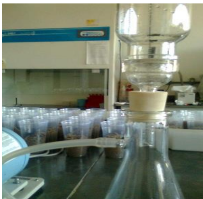
Figura 11: Filtração a vácuo para separação do micélio
