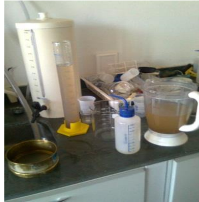
Figura 10: Retirada da alíquota de 500 mL, após repousar por dois minutos em liquidificador
