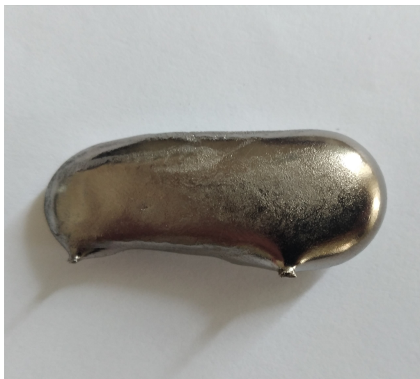
Figura 13 – Amostra fundida da LAE MoNbNiTiZr
