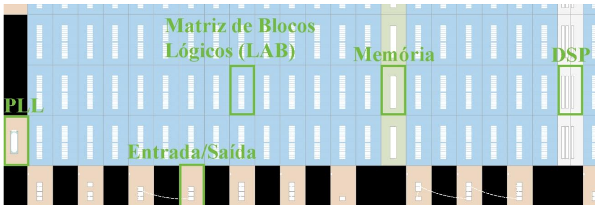
Figura 6 - Blocos da FPGA Cyclone IV® da Altera® mostrados no floorplan do software Quartus II.
