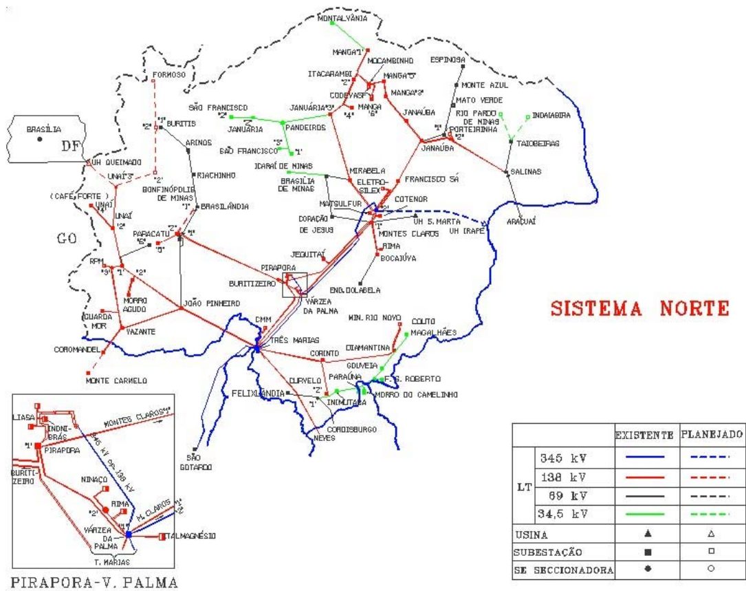
Figura 5.2: Sistema Elétrico Região Norte
