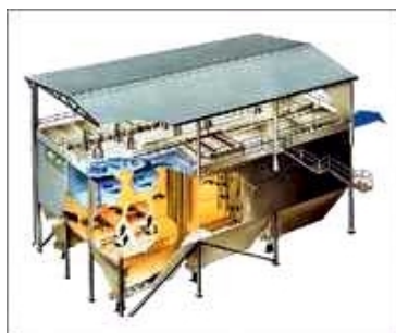
Figura 2.13: Filtros de Mangas (ALSTOM POWER).
