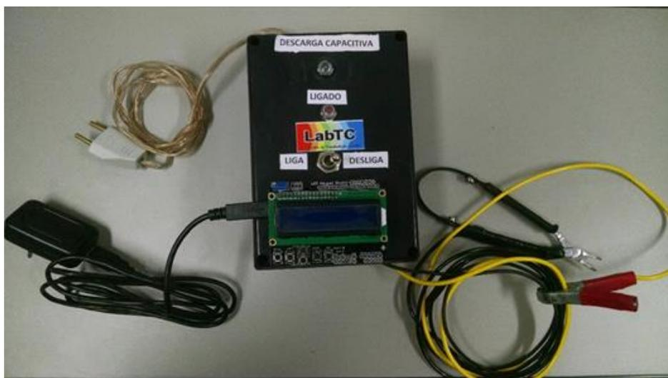
Figura 4.7 - Equipamento microcontrolado de solda por descarga capacitiva.
