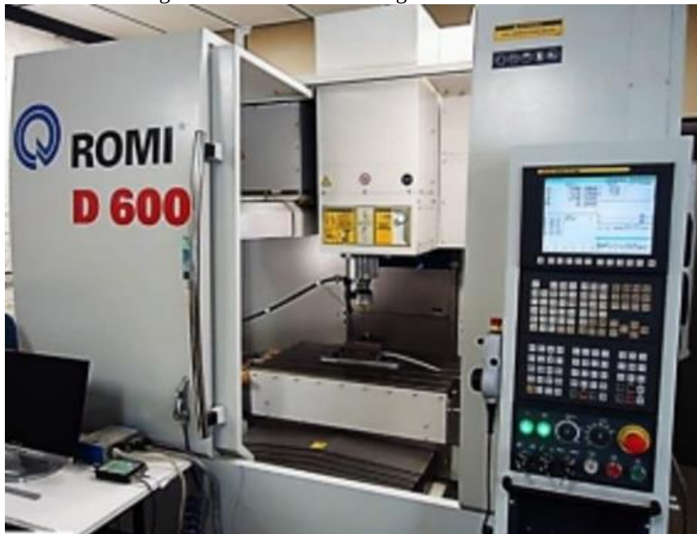
Figura 5.2 – Centro de usinagem ROMI® D 600
