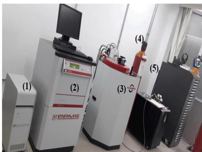
**Figura 3.5** – Imagem do PPMS usado para as medições de magnetotransporte sendo: (1) e (2) os módulos principais, (3) o módulo com *dewar* (He liquefeito) e bobina supercondutora, (4) cilindro de gás hélio 99,999% e (5) *no-breaks* para o módulo principal e compressor.
