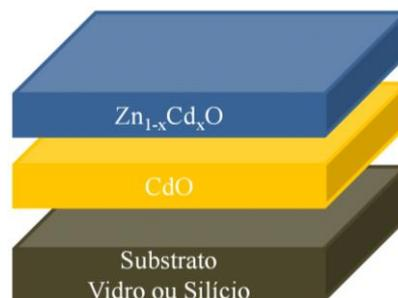
**Figura 3.2** – Esquema ilustrativo da heteroestrutura  $Zn_{1-x}Cd_xO/CdO$  no substrato de vidro ou silício após da deposição das camadas que a compõem.
