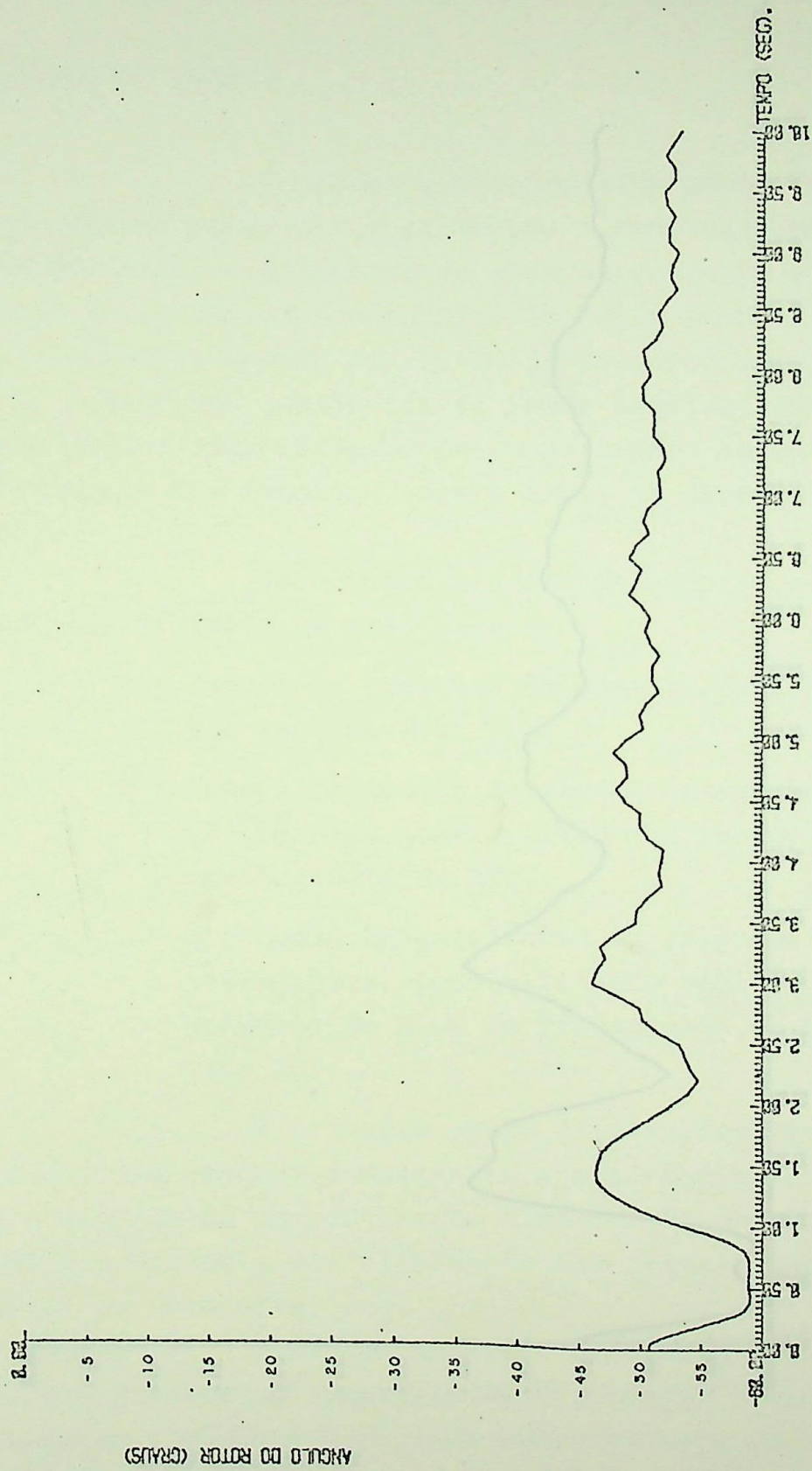
FIGURA 5.29 - Característica \delta = f(t) (Barra 4), com modulação combinada de potência e tensão DC
