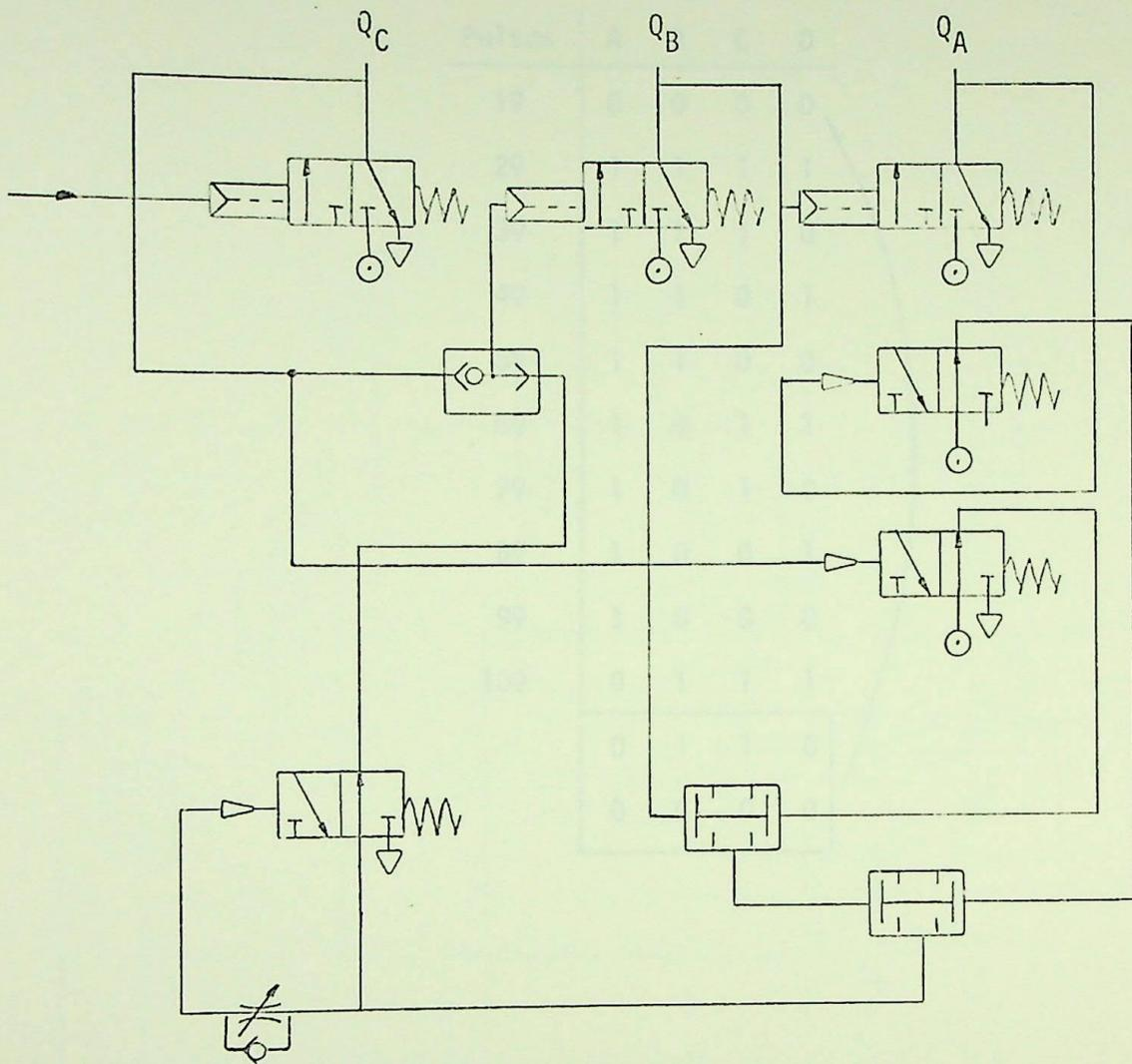
EXEMPLO 3 Esquematizar um contador assíncrono para contar de 0 a 9, usando flip-flop T com conexão Q.
