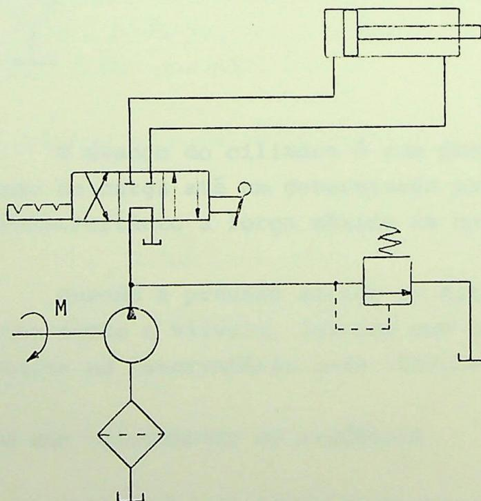
O menor dos elementos normais que o compõe , um ponto importante no cilindro de dupla ação é a diferença entre a velocidade de avanço e retorno. Devemos, ainda, analisar a velocidade do fluido que retorna ao reservatório, no avanço e no retorno, e compará-las, principalmente se os dutos de ligação
