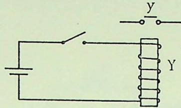
FIG. 6.2 - RELÉ COM CONTATO NORMAL ABERTO
