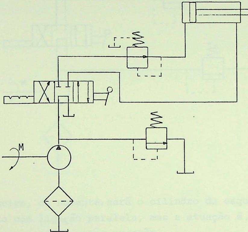
O avanço do cilindro é com pressão limitada, isto é, ela depende da carga até um determinado ponto previamente calibrado no máximo. Portanto a força máxima na haste também é limitada.
