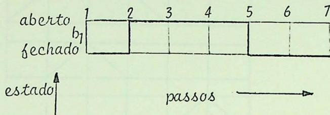
A válvula abre no passo 2 e fecha no passo 5.
