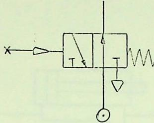
Após um determinado tempo, o fluxo de ar que passa através do controle faz com que a pressão na válvula 3/2 vias N.A. comece a crescer até que haja força suficiente para comutá-la.
