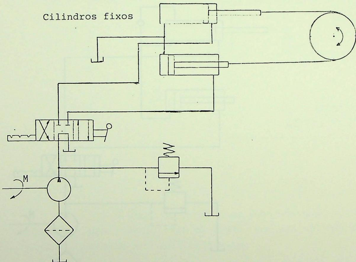
Este tipo de ligação dos dois cilindros é feito com o lado do pistão ligado ao reservatório apenas para respiro e se houver vazamentos.
