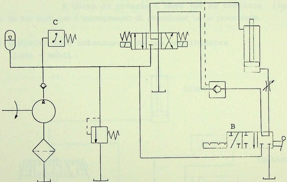
O circuito hidráulico para operação normal é o circuito convencional, como mostrado, com uma válvula duplo solenóide, centrada por mola, 4/3 vias.
