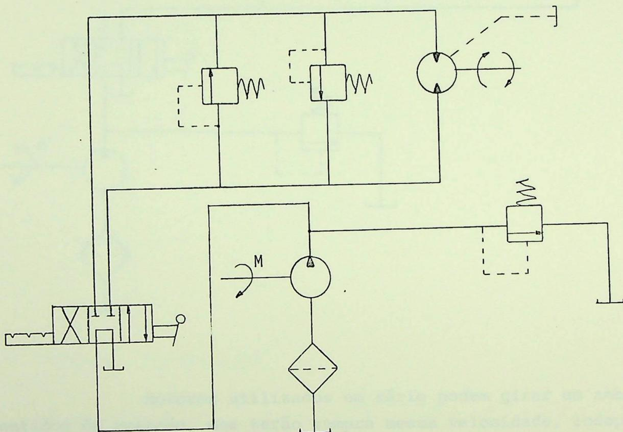
Devemos tomar cuidado quando paramos o motor, pois, devido à energia cinética de rotação, ao fecharmos a válvula direcional, o motor tentará continuar a girar, atuando, então, como uma bomba aumentando a pressão na tubulação; no entanto se usarmos uma válvula de alívio em paralelo se o motor for unidirecional, ou duas válvulas se o motor for bidirecional, teremos a circulação do fluido pelas válvulas com conseqüente dissipação de energia.
