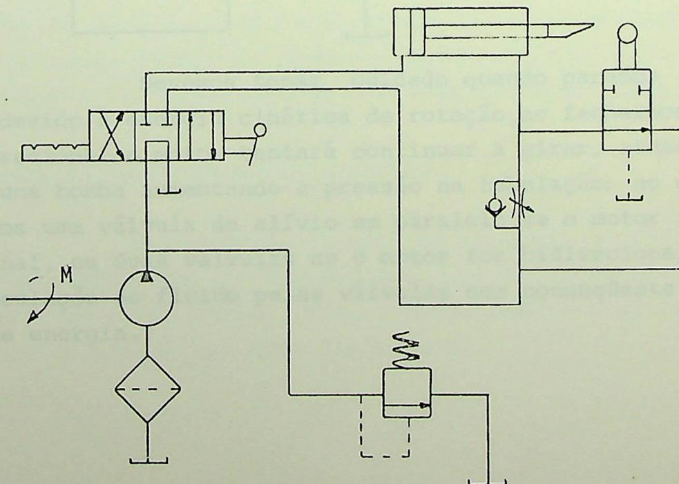
A válvula desaceleradora introduzida neste circuito é uma válvula direcional acionada mecanicamente pela haste, e é uma do tipo 2/2 vias. Quando o cilindro avança, num determinado ponto, o came da haste aciona a válvula desaceleradora fechando-a e obrigando o fluido a passar pela válvula de controle de fluxo.
