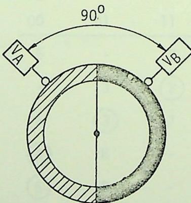
Duas válvulas 3/2 vias, RM, NF, são colocados a  $90^\circ$  sendo cada uma acionada por um came.
