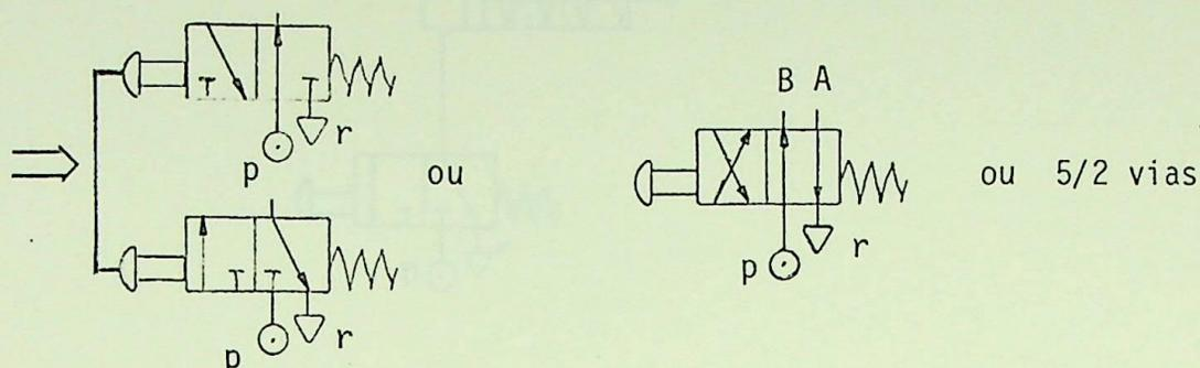
Analisando os circuitos pneumáticos acima, notamos que um "contato pneumático" necessita ao mesmo tempo que desenvolve uma situação lógica de alguma outra operação, pois, quando abrimos um "contato pneumático", temos necessidade de fechar a alimentação e comunicar o cilindro, no lado que foi pressurizado, com a atmosfera.
