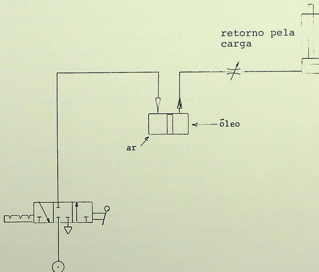
Este circuito é do tipo hidropneumático, onde o óleo normalmente usado é do tipo solúvel, a fonte de ar comprimido é um compressor.
