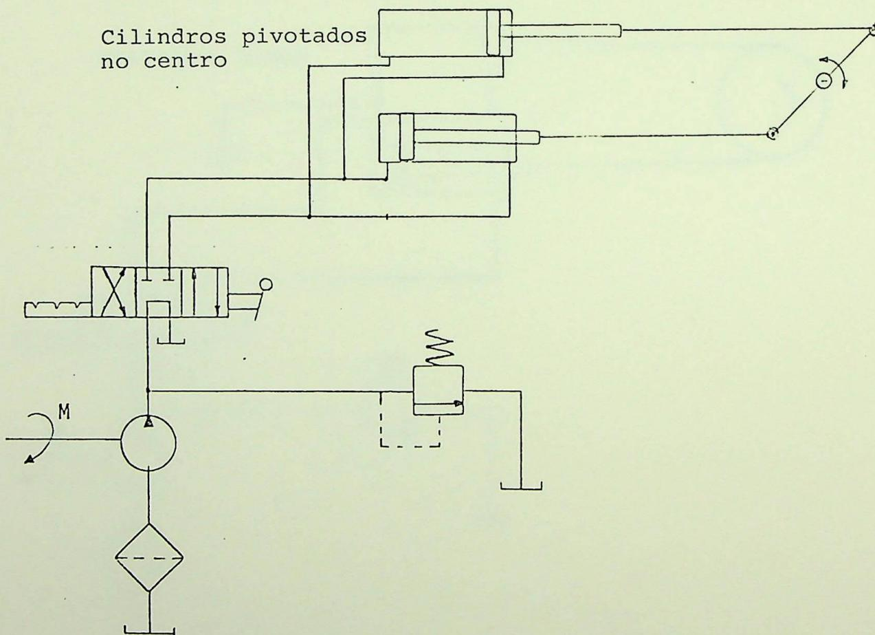
Notamos que as ligações dos dois cilindros são tais que o lado da haste de um cilindro é ligado em paralelo com o lado do pistão do outro cilindro, e que ambos avançam e retornam sincronizados com a mesma velocidade. Esta sincronização tem que acontecer, pois as hastes são pivotadas em uma barra rígida giratória.
