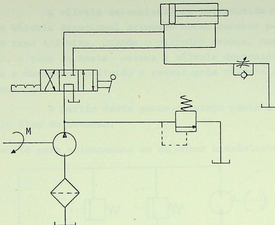
Neste terceiro tipo o controle é feito através do desvio do fluido para o tanque. Portanto parte do fluido vai para o atuador e parte retorna ao tanque. A pressão da bomba é praticamente aquela do atuador.
