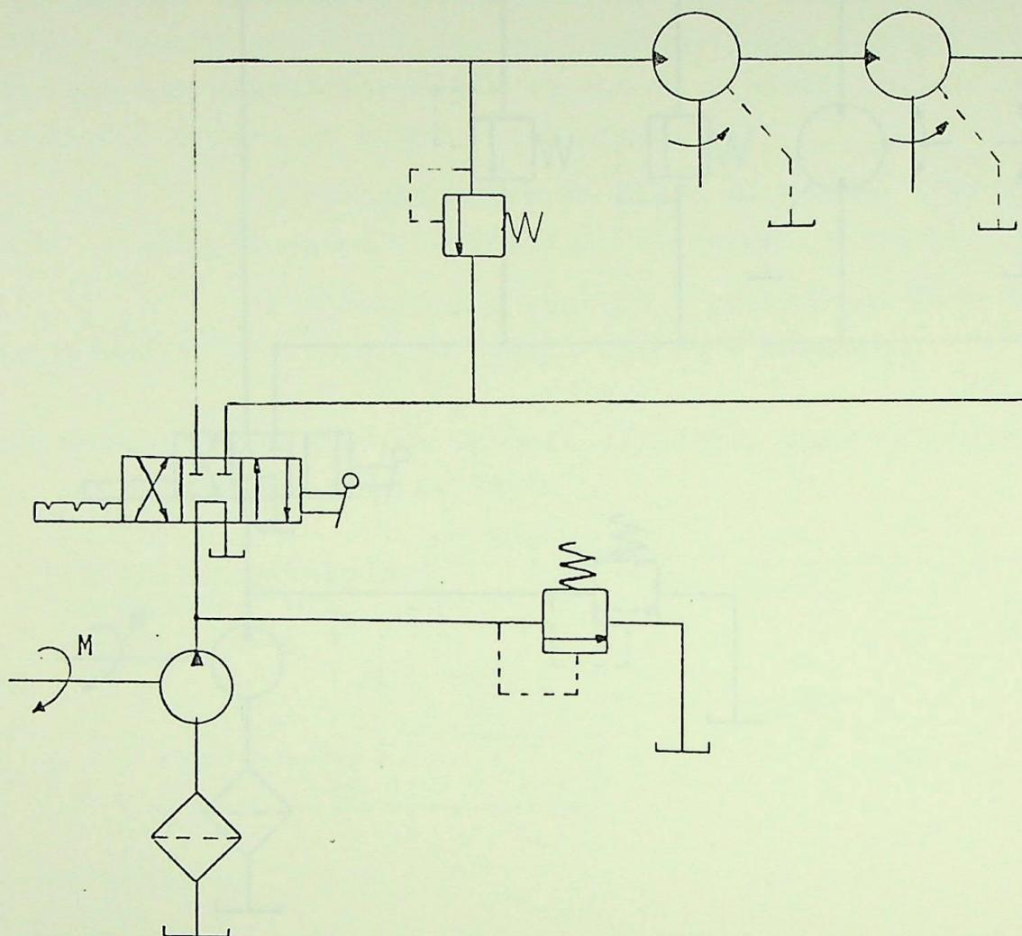
Motores utilizados em série podem girar em ambos sentidos de rotação, mas terão sempre mesma velocidade, independente da carga desde que tenham o mesmo tamanho. Este tipo de esquema pode ser utilizado em esteiras transportadoras.
