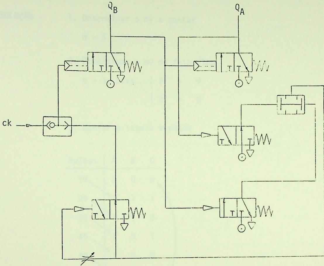
EXEMPLO 2 Esquematizar um contador assíncrono para contar de 0 a 5, usando flip-flop T com conexão Q.
