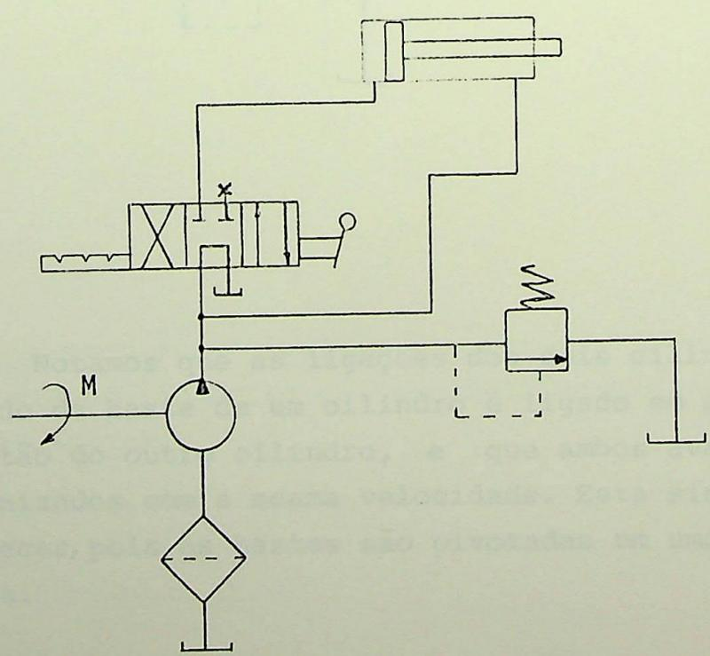
Circuito regenerativo é um tipo especial que utiliza o óleo do retorno do lado da haste do cilindro para, adicionado àquele que é enviado pela bomba, fazer com que o avanço se faça com velocidade maior do que na ligação convencional, quando apenas o óleo da bomba é utilizado.
