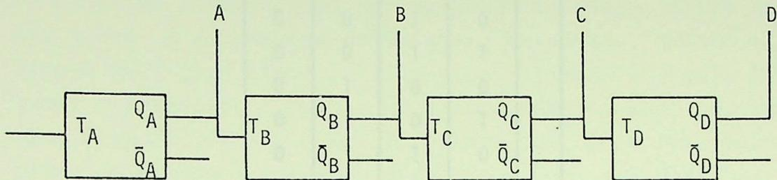
A saída normal de cada flip-flop é ligada à entrada T, ou de clock, do próximo flip-flop. Os pulsos de entrada que deverão ser contadores são aplicados à entrada T do flip-flop A.
