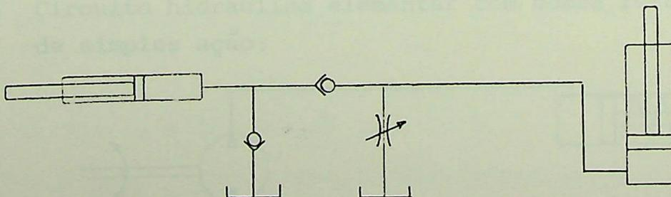
Neste tipo de circuito normalmente temos um cilindro concêntrico, onde o interno é atuador e o volume entre este e o externo é o reservatório.
