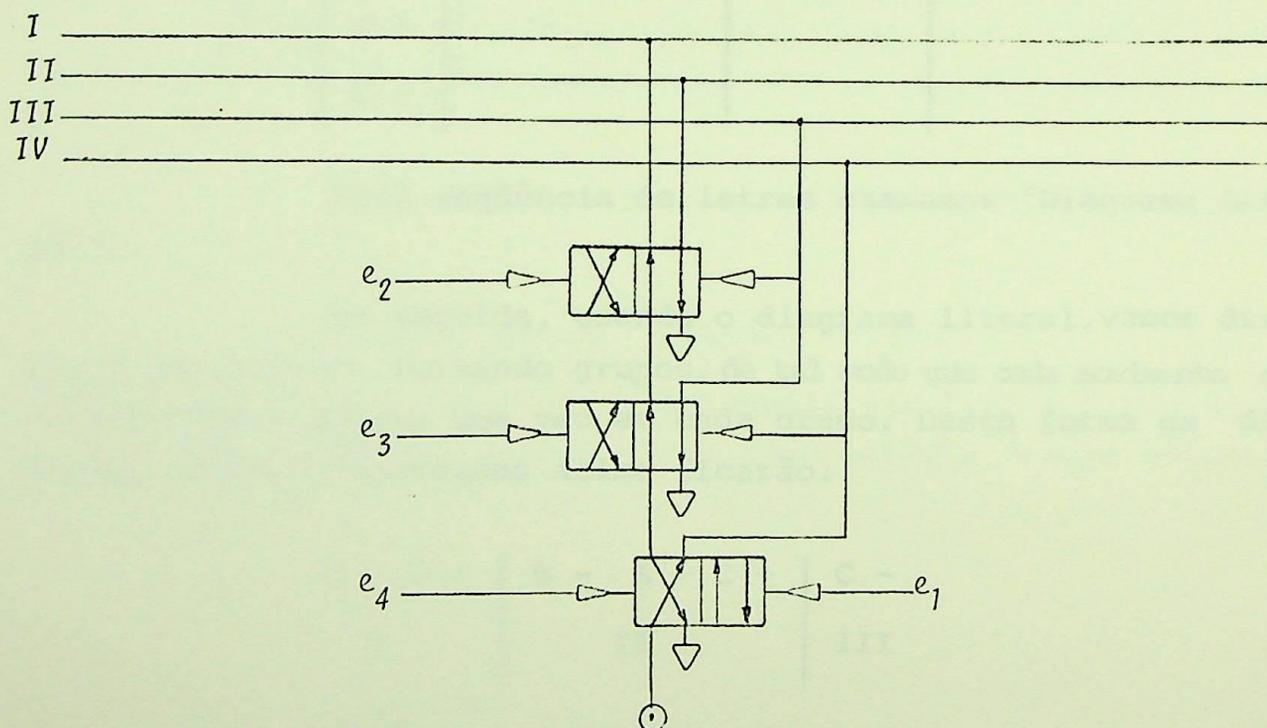
Analisando o circuito específico acima, notamos que o sinal  $e_1$ , sinal de início do ciclo, coloca ar na linha I. O segundo sinal  $e_2$  coloca ar na linha II; o sinal  $e_3$  coloca ar na linha III; e o sinal  $e_4$  coloca ar na linha IV.
