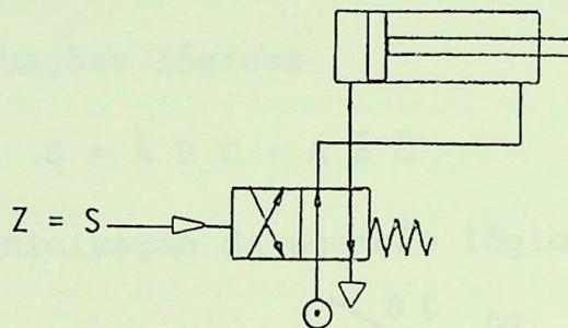
3. Devemos notar que, se a equação lógica final contém termos complementares, há necessidade de uma válvula 4/2 vias ou 5/2 vias.
