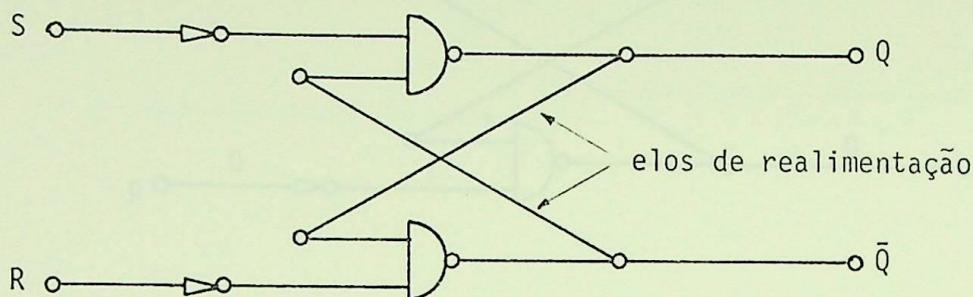
Notamos que esses elos de realimentação fazem com que sejam injetadas juntamente com as variáveis de entrada, ficando claro, então, que o estado que as saídas irão assumir, irá depender das variáveis de entrada.
