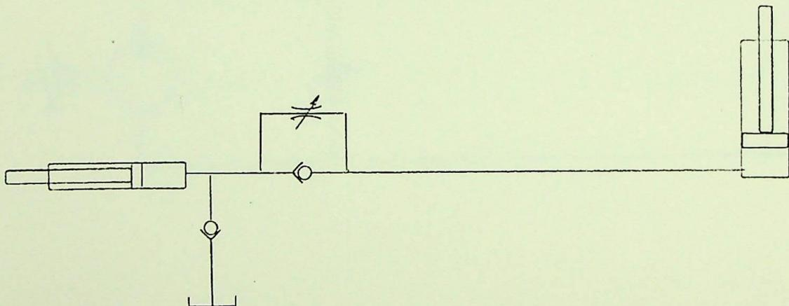
É composto basicamente dos mesmos elementos do circuito 1, acrescentando-se um duto flexível. Fisicamente, podemos destacar o conjunto bomba-válvulas, o duto e o atuador.
