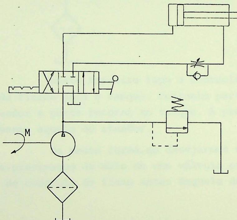
A restrição ao escoamento é feito por uma válvula de controle de fluxo no fluido de retorno. Isto faz com que o fluido do lado do pistão tenha a pressão aumentada, fazendo com que parte do óleo seja desviado pela válvula de segurança.
