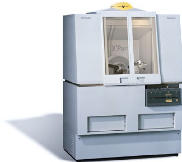
Figura 3.7 – Difratorômetro de Raios-X, Panalytical X'pert PRO Fonte: Laboratório de Caracterização Estrutural IEM / UNIFEI
