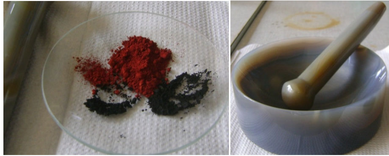
Figura 3.2 – Pós-cerâmicos em proporções estequiométricas e um almofariz de ágata
