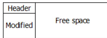
Figura 22: Metadado Modified adicionado à classe Page . O dado lógico é setado quando o bloco é modificado e verificado pelo método flushPage() na finalização de uma sessão.
