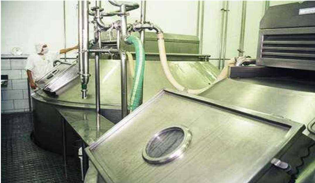
Figura 4.2 – Empresa Leitaria de Minas – Tanque de Fermentação e Coagulação
