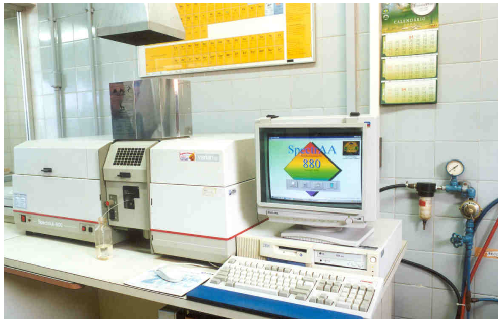
Figura 3.6. Espectrofotômetro de Absorção Atômica da marca Varian modelo SpectrAA-880 para Efetuar as Medidas de Análise de Ferro.
