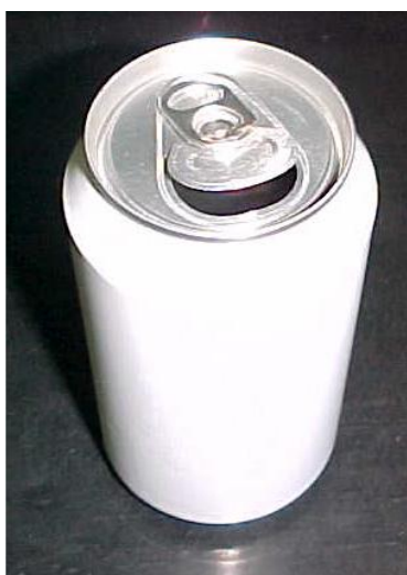
Figura 4.55. Fotografia Ilustrativa da Lata DWI com a Região de Semicorte da Tampa de Alumínio Rompida.
