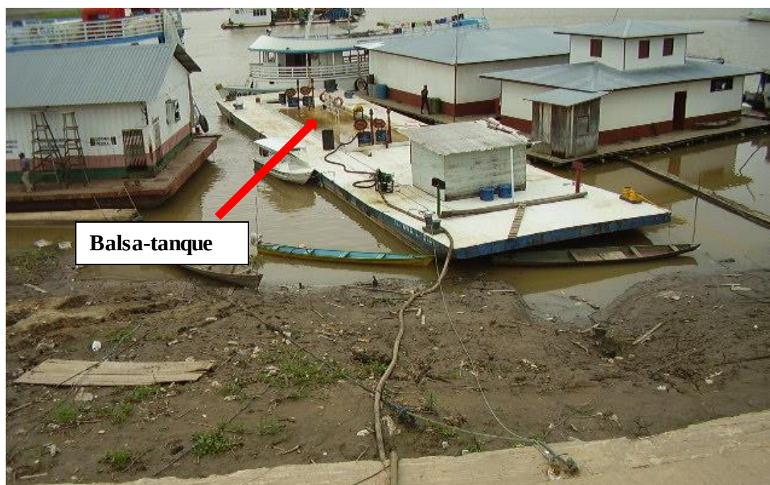
Figura 2-11 Balsa-tanque para transporte de combustível
