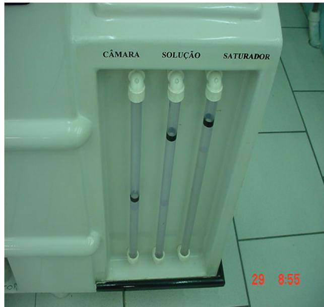
Figura 24 – Vista do Reservatório de solução salina da câmara de névoa salina.
