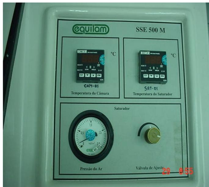
Figura 23 – Painel de controle da câmara de névoa salina.
