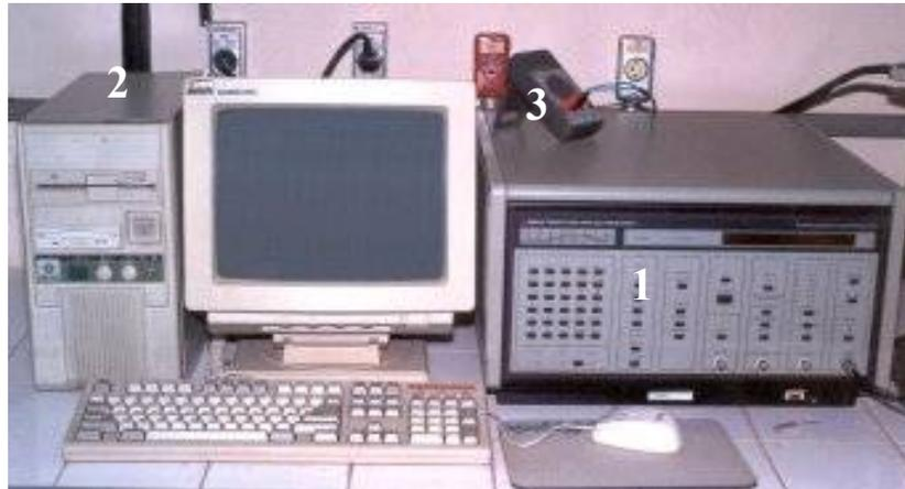
Figura 17 – Equipamento usados para levantamento das curvas de polarização. Potenciostato/Galvanostato EG&G modelo 273-A (1), microcomputador (2) e um voltímetro (3).
