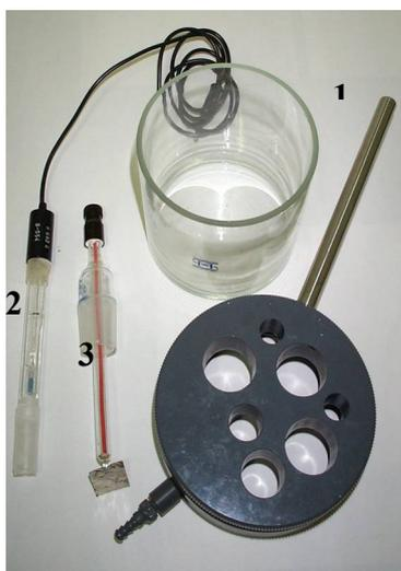
Figura 20 – Célula eletrolítica (1) com o eletrodo de referência (2) e o contra-eletrodo de platina (3).
