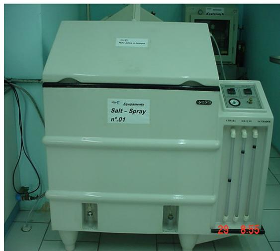
Figura 22 – Vista frontal da câmara de névoa salina.
