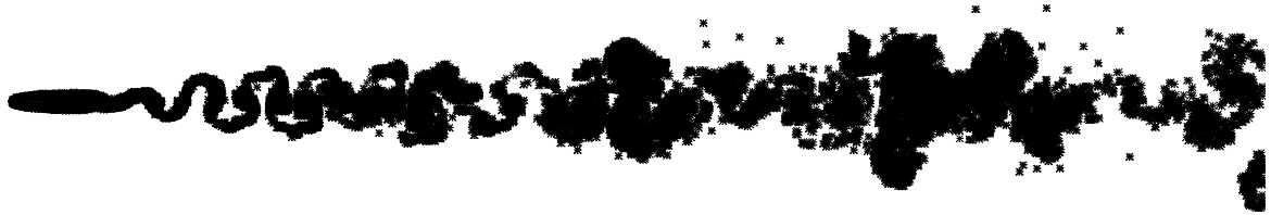
Figura 5.4. Aerofólio NACA 0012: Posição dos vórtices na esteira no instante t=30 . M=50 , \Delta t = 0,05 , \varepsilon=\sigma_0=0,00085 , Re=10^6 , A = 0.0 , f = 0.0 e \alpha = 0^\circ .
