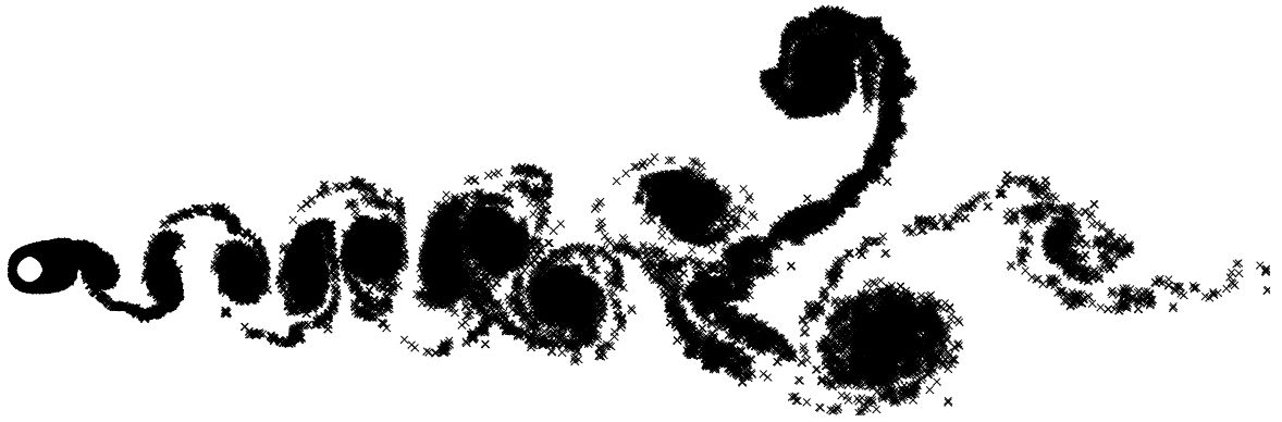
Figura 5.2. Cilindro circular: Posição dos vórtices na esteira no instante t=40 . M=50 , \Delta t = 0,05 , \varepsilon=\sigma_0=0,009 , Re=10^5 , A = 0.0 , f = 0.0 .
