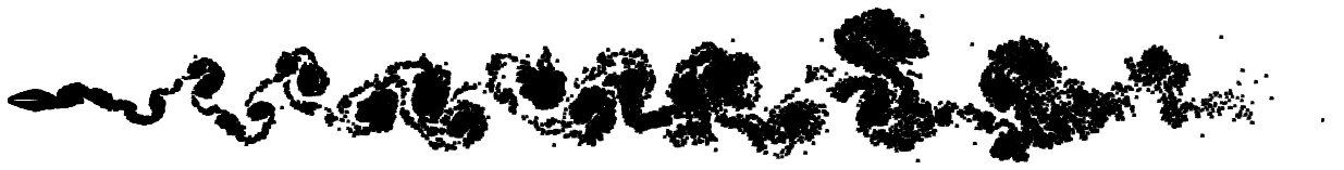
Figura 5.10. Aerofólio NACA 0012: Posição dos vórtices na esteira no instante t=30 .
