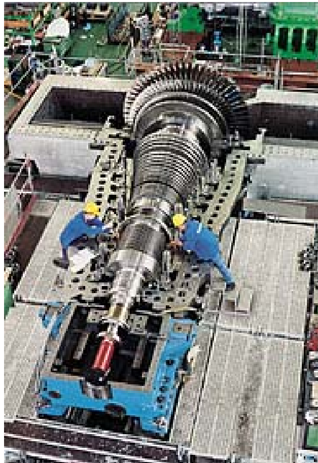
Figura 2.63: Foto de uma turbina a vapor do tipo HN. Fonte: Siemens (2003).
