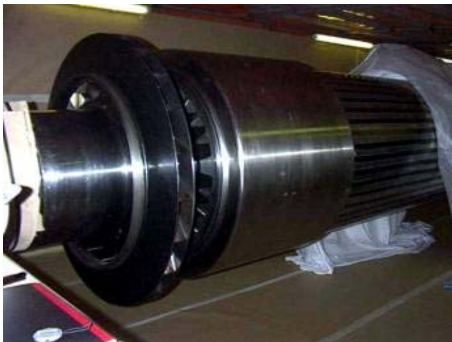
Figura 5.16: Foto do rotor de um dos geradores de Drax. Fonte: AES Drax Power Ltd (2002).
