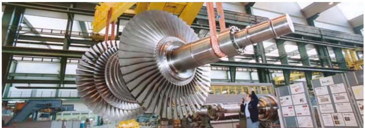
Figura 2.64: Foto de um rotor suspenso de turbina a vapor de fluxo duplo. Fonte: Alstom (2003).
