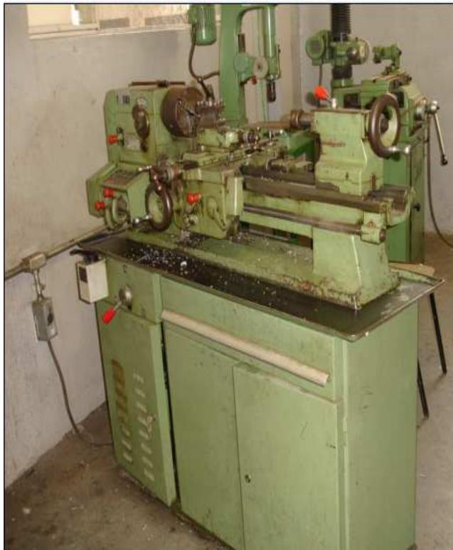
**Figura 26** - Torno mecânico marca Sanches Blanes S.A , modelo T.M.280. Rotação do torno 1500 r.p.m., utilizado para os cortes dos cilindros dos sistemas DGEBA-TETA, DGEBA-DETA e DGEBA-AEP no formato de discos.
