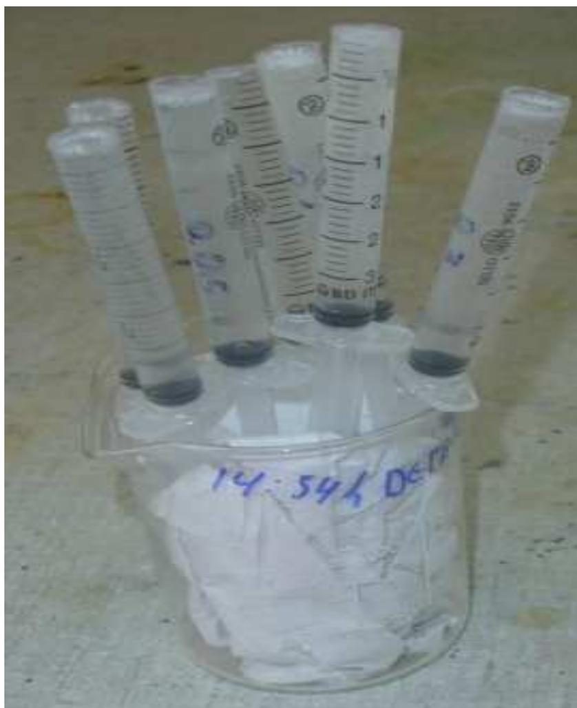
**Figura 24** - Preparo dos cilindros dos sistemas epoxídicos DGEBA/TETA, DGEBA/AEP e DGEBA/DETA, utilizando-se seringas descartáveis como molde.
