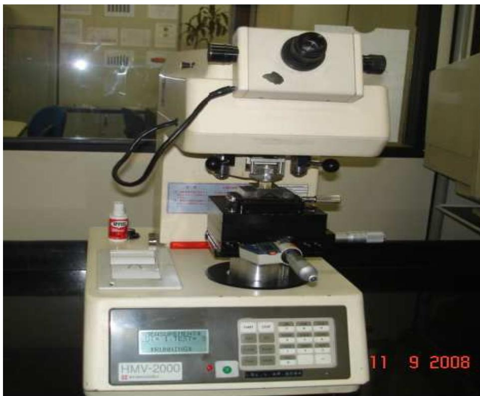
**Figura 29** - Equipamento HMV 2000, Shimadzu – Laboratório de ensaios mecânicos da Mahle.
