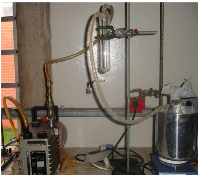
**Figura 21** - Sistema montado para a desidratação da resina DGEBA sob vácuo.
