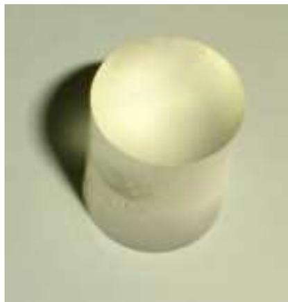
**Figura 28** - Disco cortado no torno mecânico marca Sanches Blanes S.A , modelo T.M.280 e lixado na Politriz DP, marca STRUERS.
