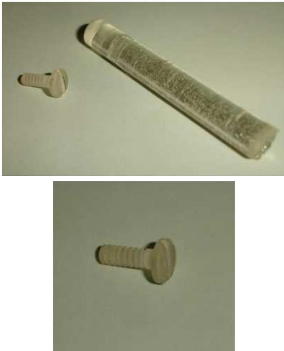
**Figura 54** - Parafusos obtidos através da usinagem de cilindros do sistema DGEBA/ DETA.
