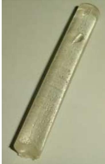
**Figura 25** - Imagem de um cilindro do sistema epoxídico curado a 37°C por 24 horas.
