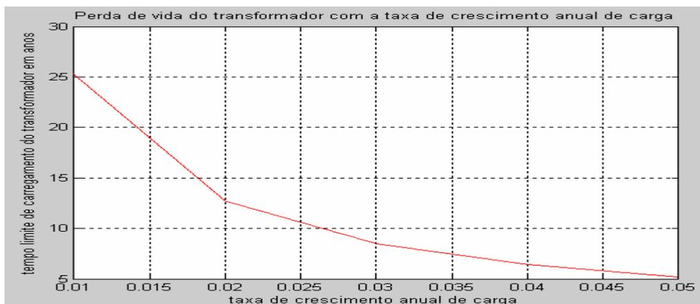
Figura 4.4 - Evolução do tempo limite de carregamento do transformador versus taxa anual de crescimento de carga
