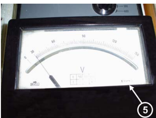
Figura A3.3 – 5) Voltímetro utilizado para medir a tensão na armadura do MCC.
