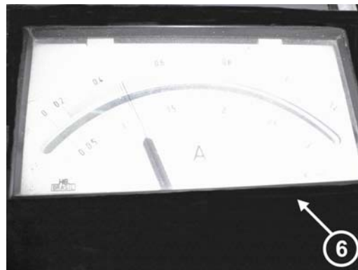
Figura A3.4 – 6) Amperímetro utilizado para medir a corrente de excitação do MS.
