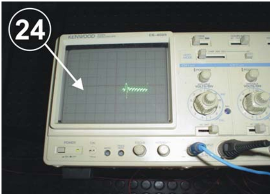
Figura A3.19 – 24) Osciloscópio utilizado para monitorar a ponte inversora.
