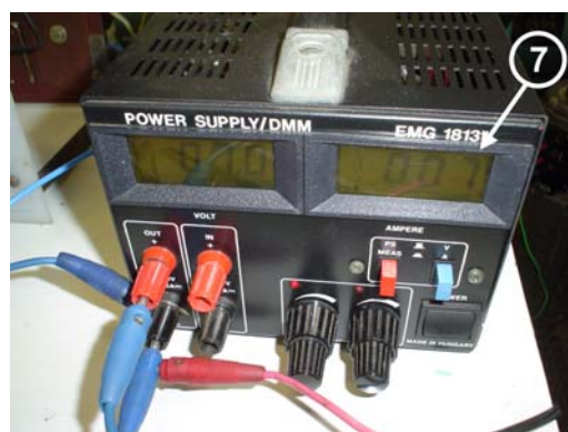
Figura A3.5 – 7) Fonte de alimentação auxiliar para o circuito de disparo do inversor.
