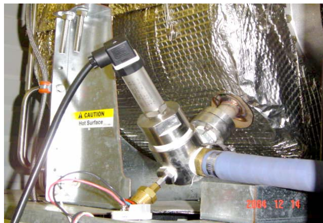
Figura 5.4 - Medição de pressão e temperatura na saída do compressor
