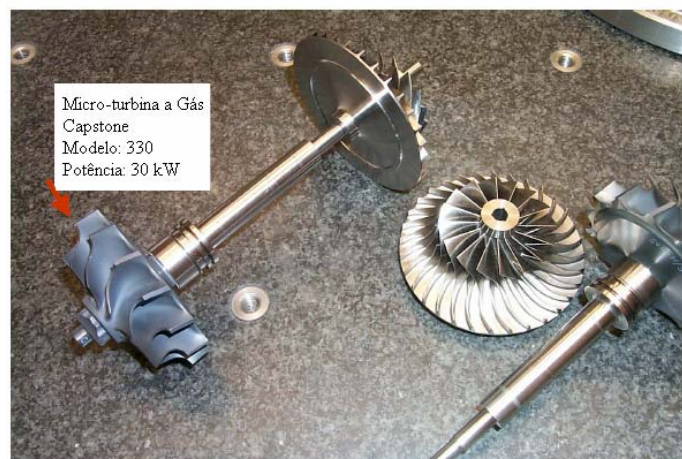
Figura 3.11 - Foto do conjunto compressor-turbina (Capstone, 2001)
