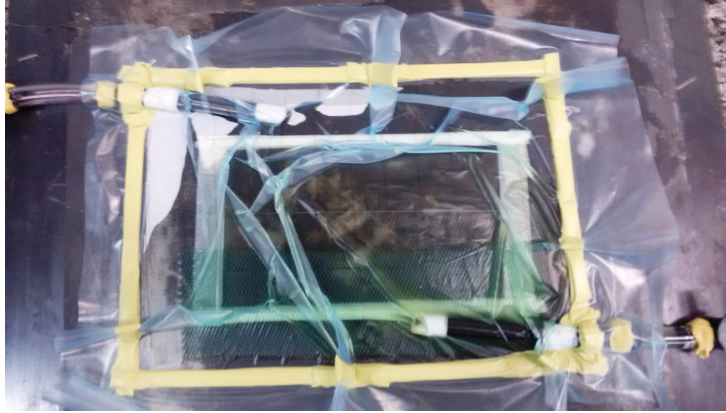
Figura 3.5: Impregnação das fibras via VARTM
