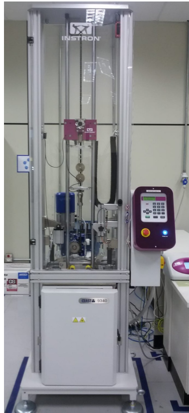
Figura 3.12: Máquina de ensaio de impacto de baixa velocidade Instron ® 9340.
