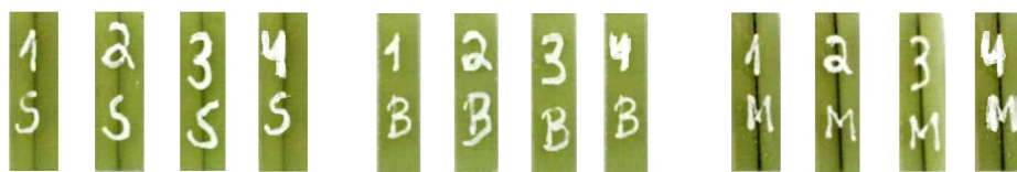
Figura 4.2: Corpos de prova de DMA Superelástico, Base e Martensítico, respectivamente.
