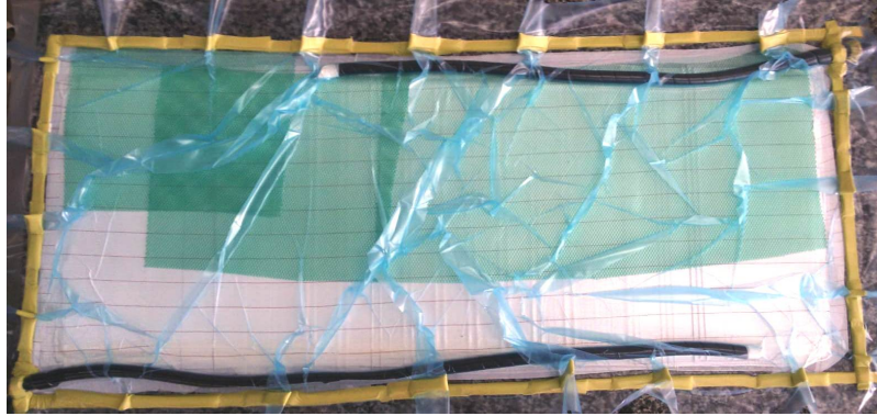
Figura 3.7: Processo VARTM com o posicionamento dos fios NiTi no laminado.
