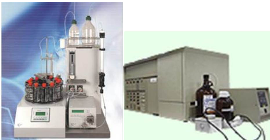
Figura 6.3: Equipamento para cromatografia de permeação em gel (GPC) Waters, modelo 510 utilizado neste trabalho. O equipamento pertence à Petroquímica União/SP.
