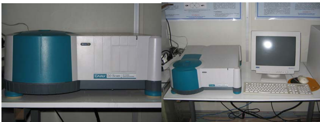
Figura. 6.1: Espectrofotômetro UV/Vis Cary 50 utilizado na caracterização do sistema \epsilon -CL:I 2 e Eg-I 2
