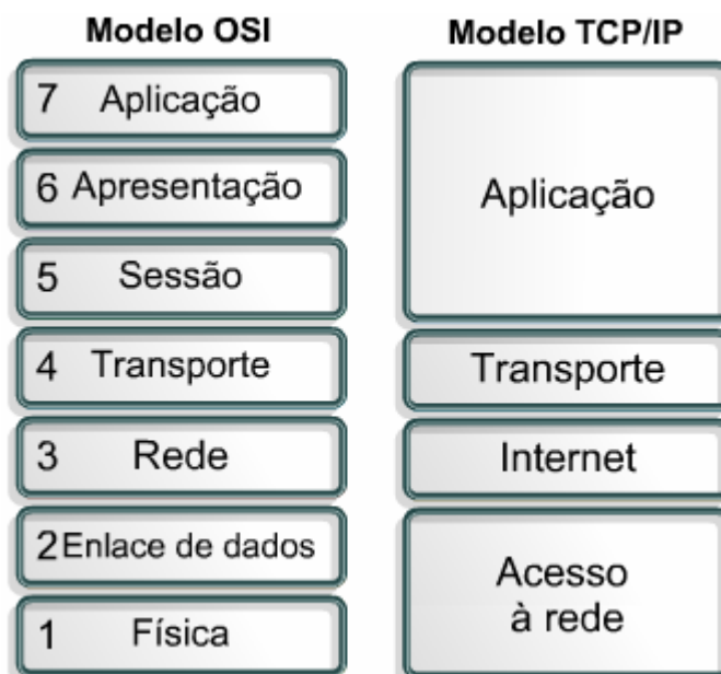
Figura 6 – Modelos de comunicação OSI e TCP/IP
