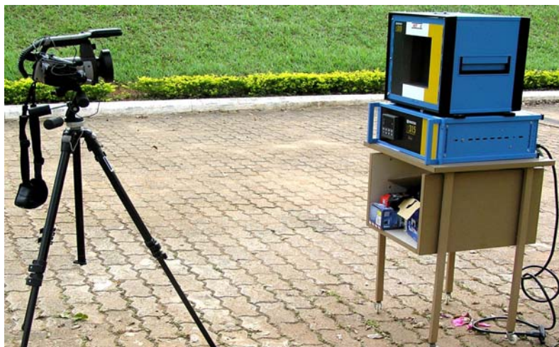
Figura 47 – Foto do ensaio para a determinação da atenuação atmosférica.
