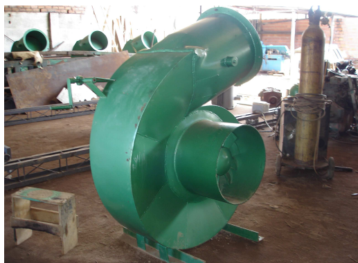
Figura 5.13 – Turbina a ser utilizada na central (ainda na oficina do fabricante).
