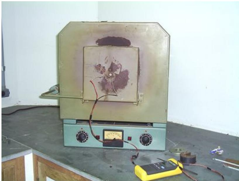
**Figura 4.11:** Forno Mufla utilizado.
