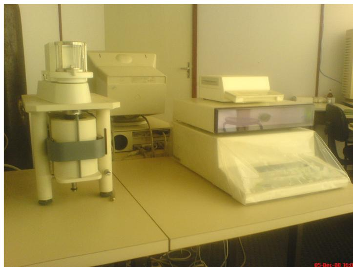
**Figura 4.15:** Equipamento TGA
