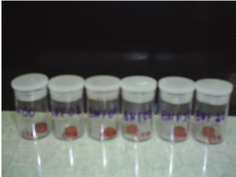
**Figura 4.8:** Pastilhas prontas para sinterização.
