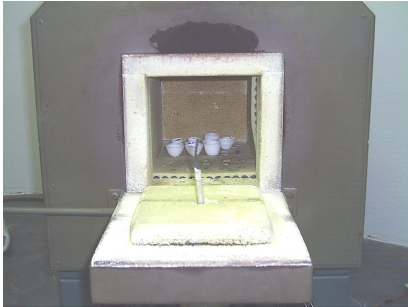
**Figura 4.12:** Cadinhos com as amostras colocados dentro do forno.
